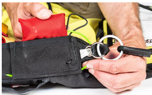
Figur 48 - Top release system korrekt förberett
