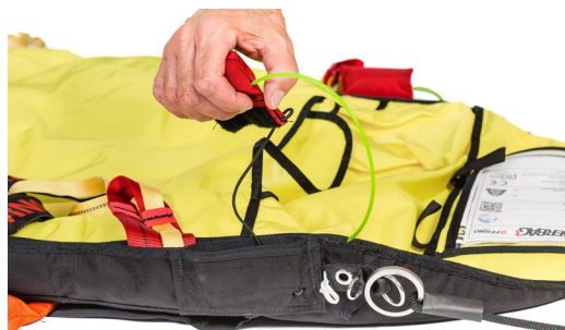
Figur 52 – Kontakten lossad från tag-linjen
