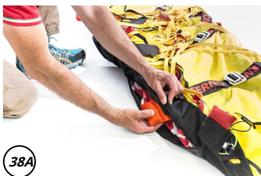
Bild 38 - Fästa handtaget på kardborrbandet
