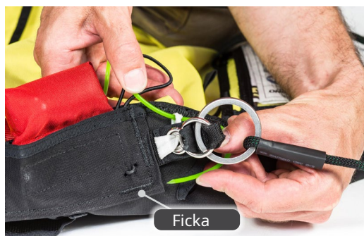
Bild 47 - Byte av det gröna snöret i fickan
