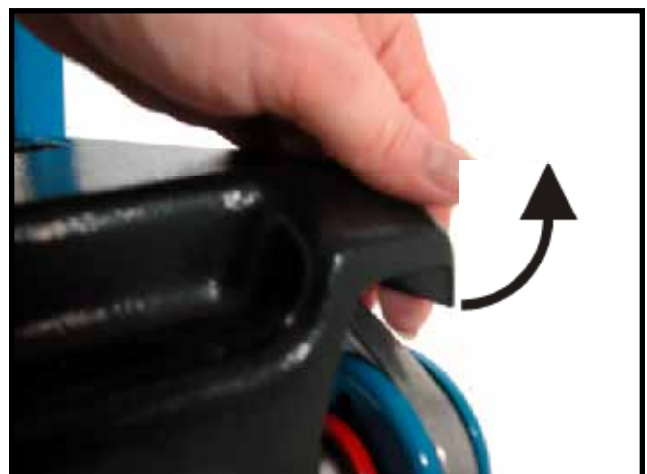
Figur 43 - Lösgöra ett horn på sittplattan
