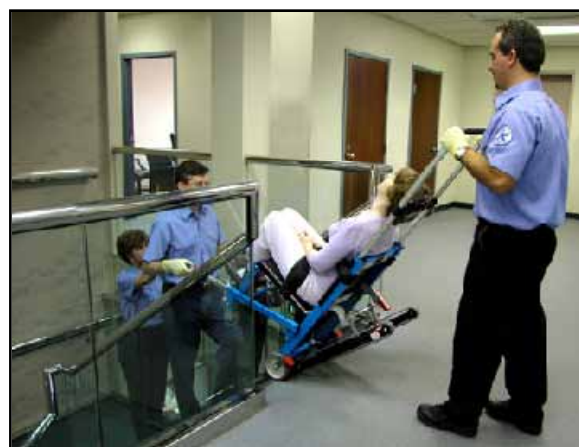
Figur 24 - Larvfötterna är i kontakt med trapp-
