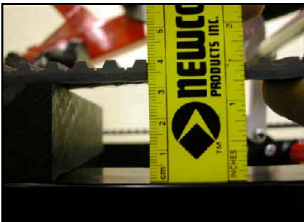
Figur 37 - Spänningskontroll med stolen vilande på larvfötterna
