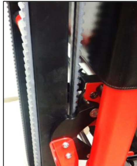
Lås festet til stolryggen via trykk for å lukke låser
